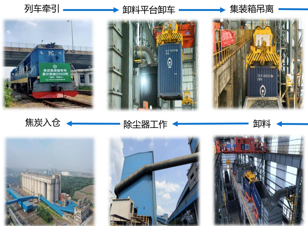
图 1 集装箱焦炭全程封闭运输以及装卸无扬尘抛洒
